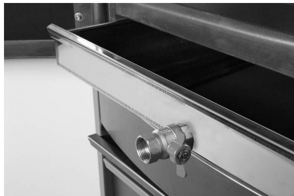
Ablassventil geschlossen. (Handhebel senkrecht)
