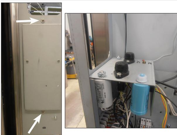
1. Retire el panel lateral derecho y el panel de operación de acuerdo con los procedimientos anteriores.
