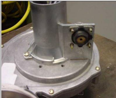
1. Retire las 4 tuercas de la entrada de aire (A) y los 4 pernos con tuerca de la entrada de gas (B) y retire el ventilador de mezcla de gas.
