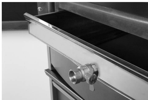
Chiudere la valvola di scarico. (Manopola in posizione verticale)
