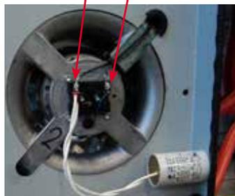
Contrôle avec Ω mètre
