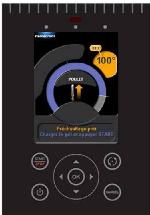
Appuyez sur la touche du rotor pour placer le rotor dans la bonne position.
