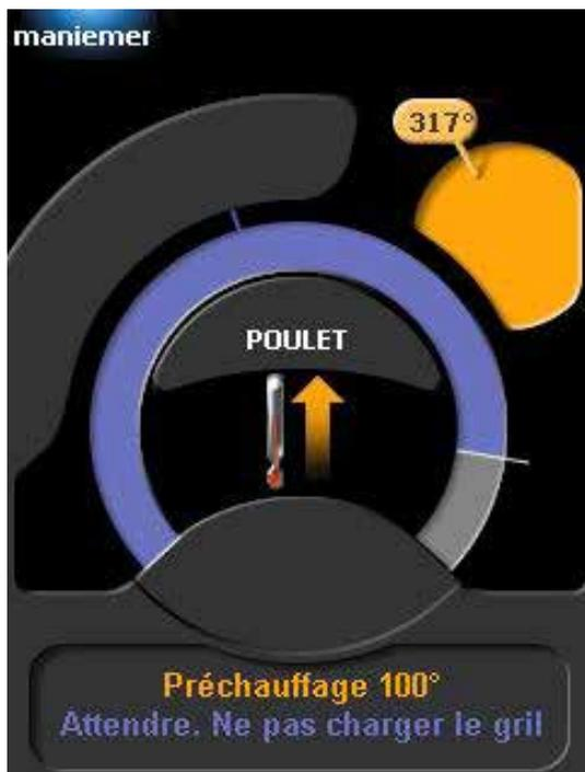
Lorsque la phase de préchauffage est activée dans le menu du responsable, la multissérie démarre avec le programme de préchauffage après le démarrage du programme. Après avoir atteint la température de préchauffage, l'affichage indiquera: charger le gril et appuyer START.
