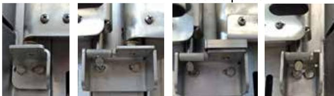
Notez qu'une rondelle est placée sous le boulon de charnière supérieure au cas où une butée de porte serait montée.
