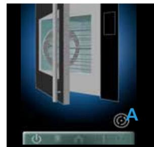
**Spiedo - step 3** Premere il pulsante del rotore sul pannello di controllo (A) Saltare alla posizione successiva e posiziona il secondo spiedo. Carica in maniera alternata le posizioni per evitare uno sbilanciamento di carico del girarrosto.
