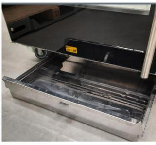
**Étape 8** N'oubliez pas de vérifier le collecteur de graisse - selon le modèle de TDR, il s'agit par exemple d'un plateau, d'un tiroir ou d'un seau.
