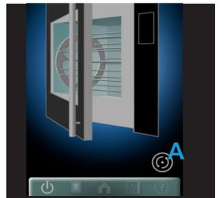
**Fourches à viande - étape 3** Appuyez sur le bouton du rotor sur le panneau de commande (A) Passez la position suivante et placez la deuxième broche. Chargez en alternant les positions pour éviter une charge déséquilibrée de la rôtissoire.
